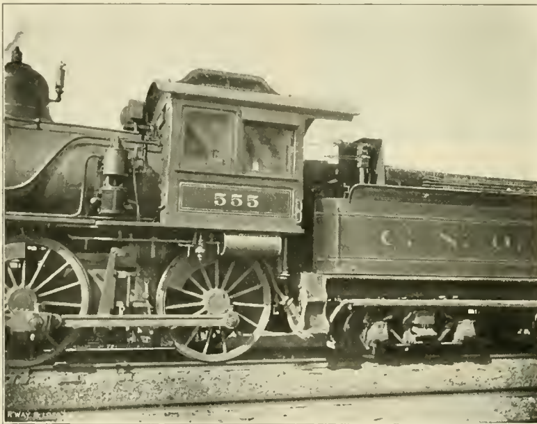
STAFF CATCHING APPARATUS ON ENGINE—C., N. O. & T. P.
